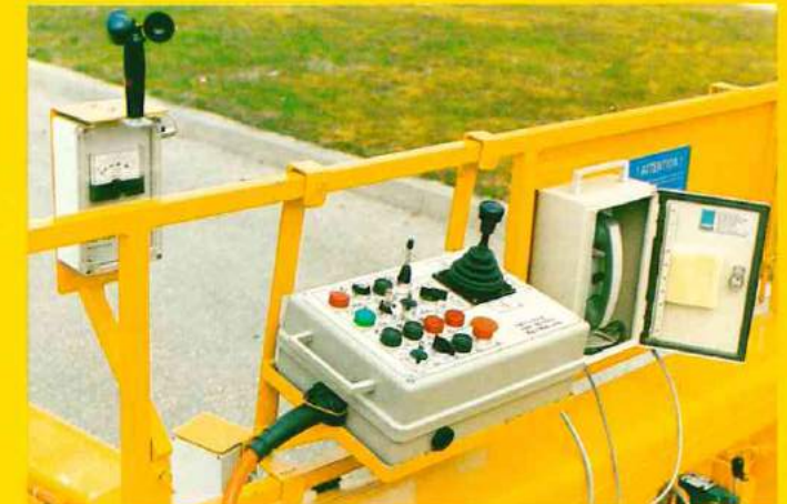
Steuertableau, Windmeßanlage und Telefon sind transportable Einheiten.
