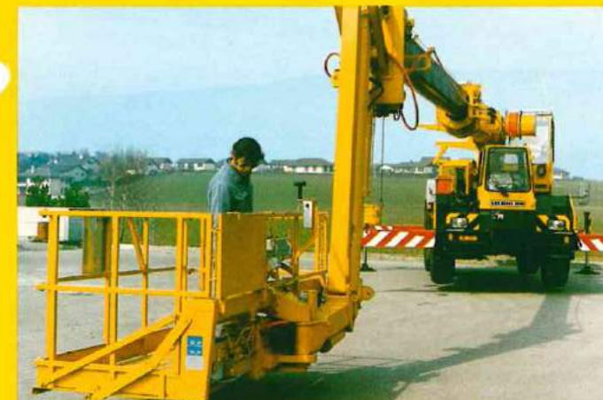
Die Plattform kann um 90° nach links geschwenkt werden. The platform can be swung through 90 degrees to the left. La plate-forme peut pivoter de 90° vers la gauche.
