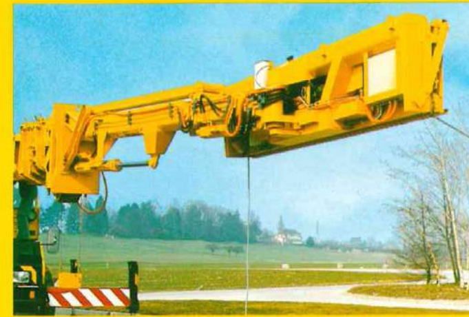
Zwischen Auslegerkopf und Bühne ist der gelenkige Tragarm angebolzt.
